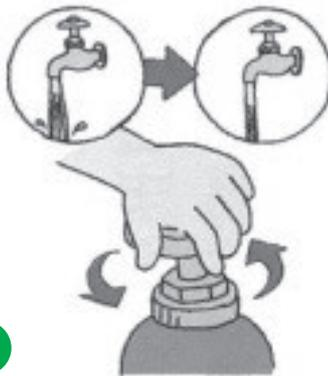
**4** 閉めた止水栓バルブを左に1回り開けて、蛇口の水の出を確認してください。通常の半分くらいの水量であれば完了です。
