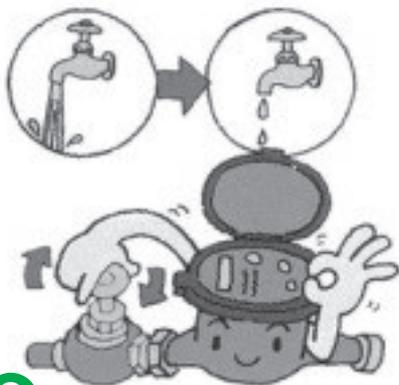
**3** 止水栓バルブを右に回し、1度完全に閉めてください。水道の蛇口で水が止まっていることを確認してください。
